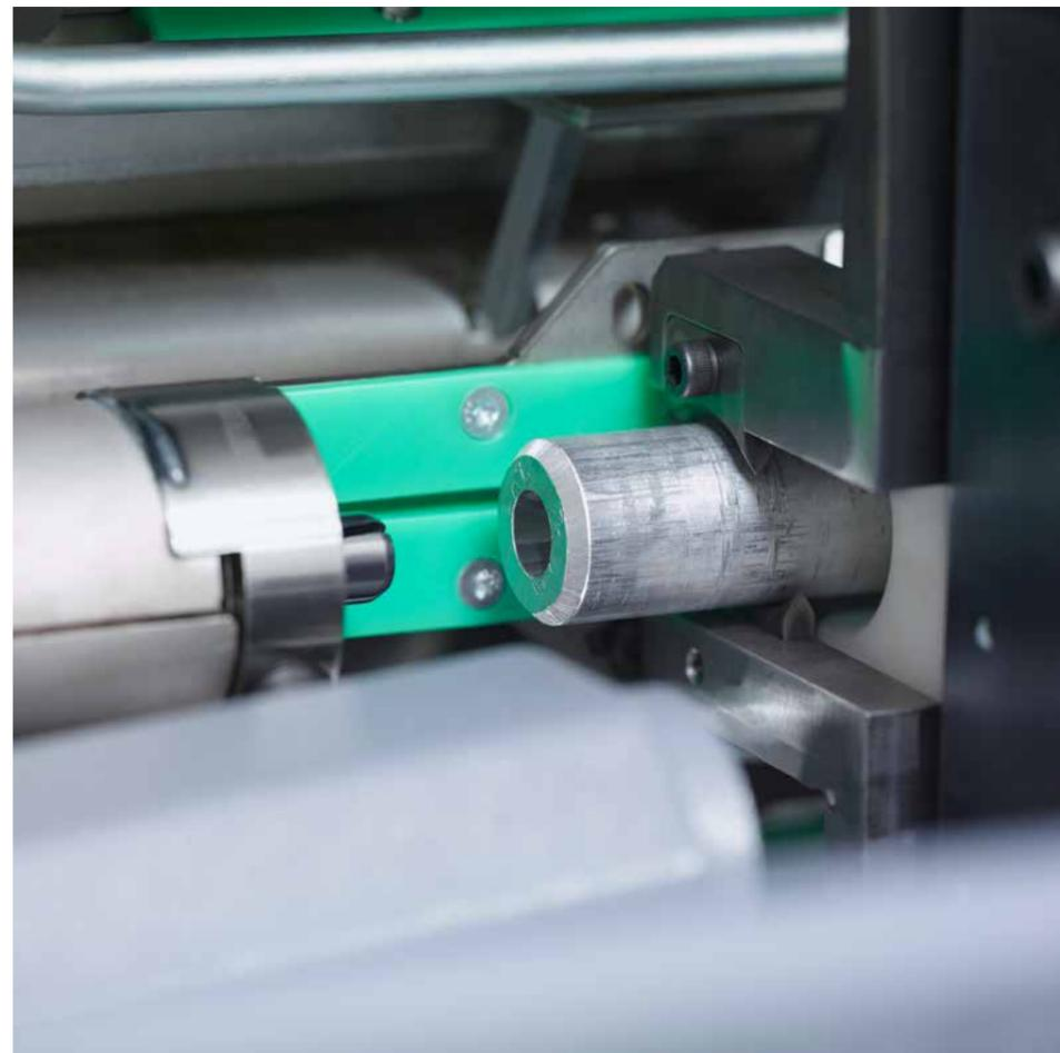
Les barres sont percées dans l'embarreur en temps masqué. Cela permet un guidage continu et entièrement concentrique de la barre.
