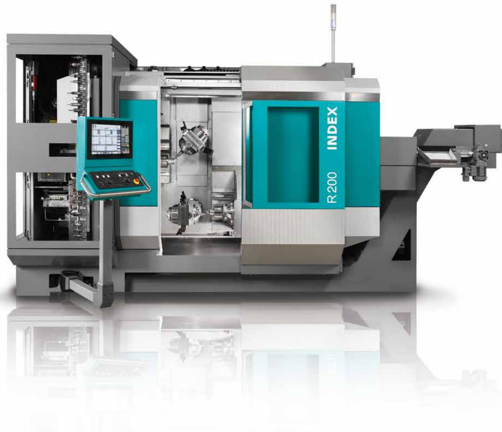
**Deux broches de fraisage autonomes, fonctionnant en simultané**
