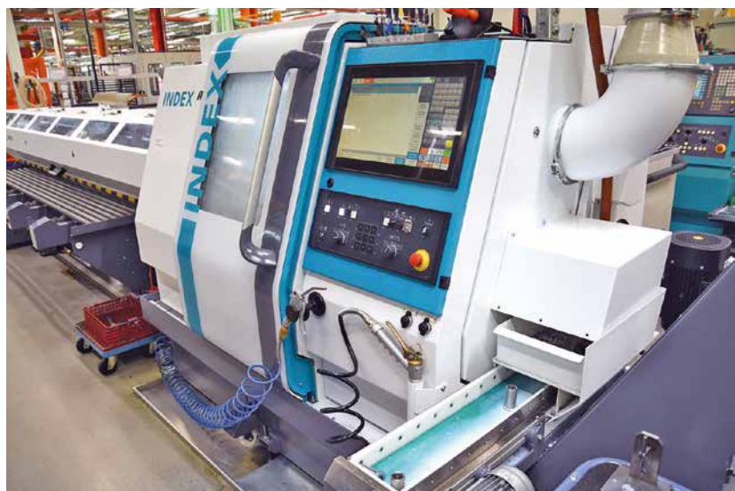
1 Die erste Index ABC im neuen Design und mit Y-Achse wurde 2022 an Müller Präzision geliefert, um eine zuvor ausgewählte Teilefamilie, die bereits auf der Vorgänger-ABC gefertigt wurde, noch effizienter produzieren zu können © Hanser
