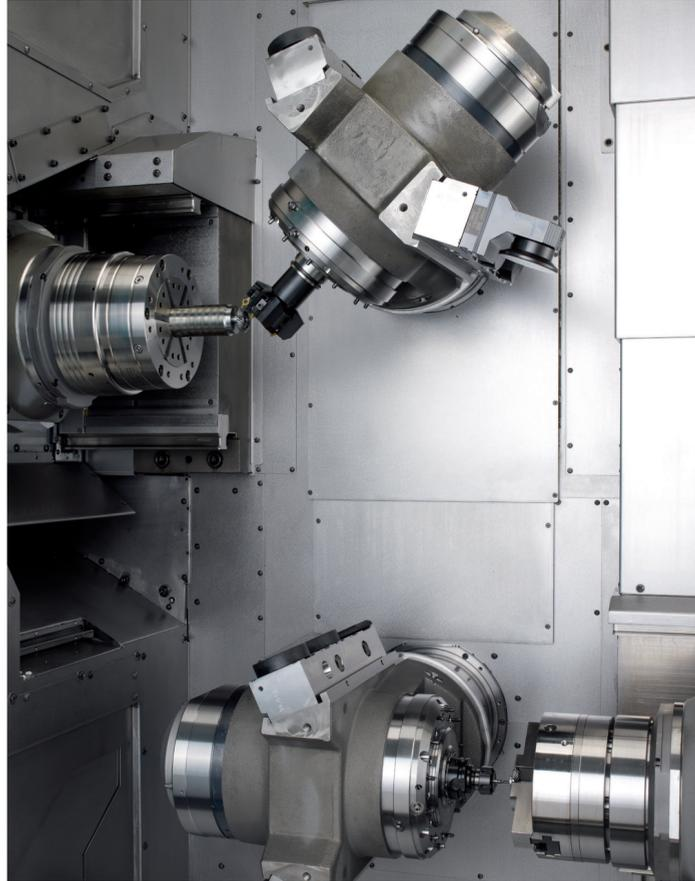
Die Dreh-Fräszentren INDEX R200 und R300 besitzen eine Haupt- und Gegenspindel. Im Arbeitsraum befinden sich zwei Werkzeugträger, die jeweils über eine Motorfrässpindel verfügen. Durch die Achskonfiguration kann man an beiden Spindeln fünffachig bearbeiten.
